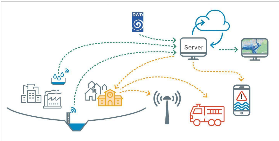
Abbildung 1: Komponenten und Datenflüsse des Starkregenvorhersagesystems für Kommunen
