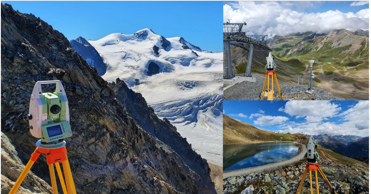
Abbildung 3: Collage aus tachymetrischen Netzmessungen auf einer Höhe von bis zu 3500m; Quelle: Eigene Aufnahmen
